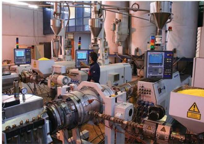
خطوط تولید این شرکت دارای مدرنترین ماشین آلات روز جهان از شرکتهای معتبر Krauss Maffei، Battenfeld و Reifenhäuser می‌باشد. این خطوط دارای سیستم هوشمند گراوی متریک جهت اندازه گیری وزن واحد لوله و سیستم‌های اولتراسونیک جهت اندازه گیری ضخامت و میزان دوپهنه می‌باشد. همچنین خطوط تولید این شرکت مجهز به سیستم Co Extruder بوده که قابلیت ایجاد نوار رنگی (آبی، زرد و ...) را بر روی لوله امکان‌پذیر می‌نماید.
